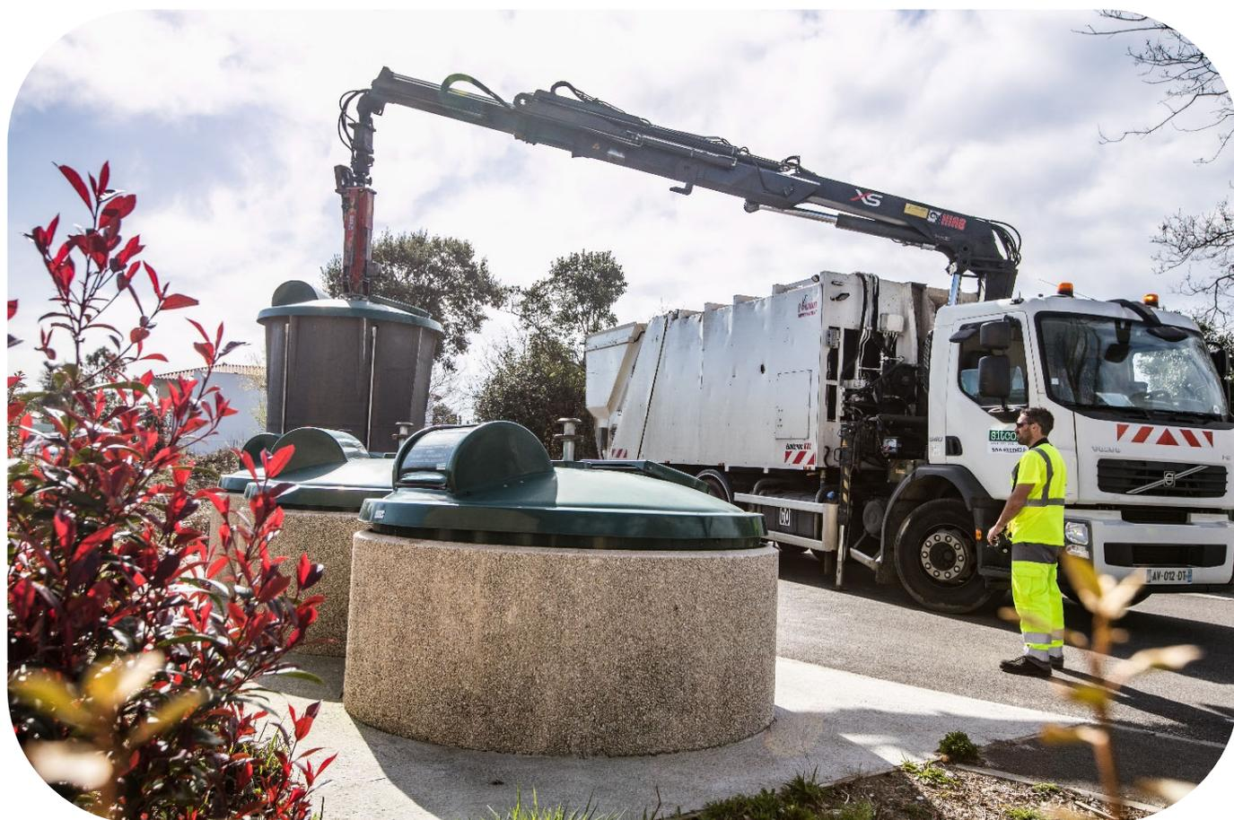
Photo d'un camion benne à ordures ménagères (BOM) à grue collectant des conteneurs semi-enterrés d'ordures ménagères
