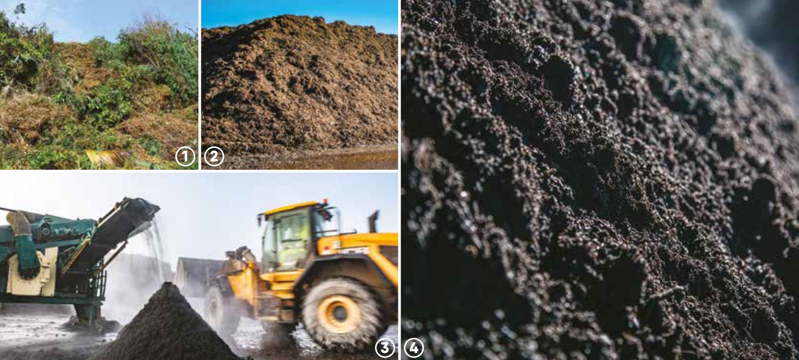
① Parc à végétaux en déchetterie - ② Compostage en andain ③ Criblage du compost - ④ Produit fini en 0/10 mm
