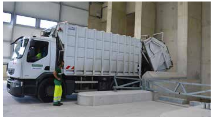
Vidange du premier camion dans la fosse à déchets
